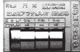
▼ Ra \mu 円筒アラサ標準片(研削用)
