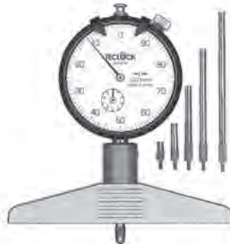
DM-214 継足の接続で、最大220mm までの深さ測定が可能 目量0.01mm 測定範囲220mm 指示範囲10mm ・継足5本付
