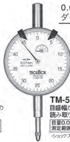
TM-110G 最大値で指針が 止まる置針機能付 目量0.01mm 測定範囲10mm ・ショックブレード ・置針装置付
