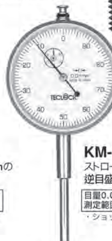
KM-121D ストローク20mmの中二針標準タイプ 目量0.01mm 測定範囲20mm ・ショックプルーフ
