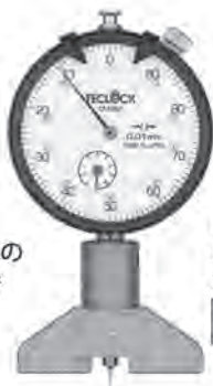
DM-252 凹凸両面の測定ができます 目量0.01mm 測定範囲凹5mm凸4mm
