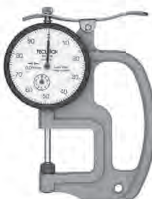
SM-528 厚さ20mmまでのワークが 測定できる小形シックネス 目量0.01mm 測定範囲20mm ・測定子、アンビル=セラミック製
