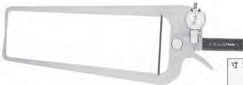
GM-3 最大測定深さ400mmの大形 目量0.1mm 測定範囲0~90mm
