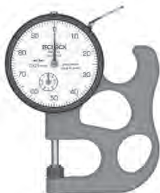
SM-112 最も標準的な シックネスゲージ 目量0.01mm 測定範囲10mm ・測定子、アンビル =セラミック製
