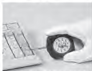
キーボードの押圧力を測定しています
