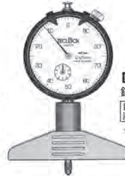
DM-211 φ2mmのニードル 測定子タイプ 目量0.01mm 測定範囲10mm
