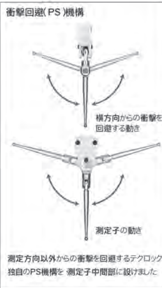
LT-316PS ロング測定子タイプ 目量0.01mm 測定範囲1.0mm
