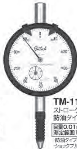
TM-110-4A 目盛板内の 排油機構付※ 目量0.01mm 測定範囲10mm ・ショックブレード ・ステンレスシステム 付
